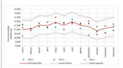
La verificación del modelo se hace a partir de la visualización de los datos del periodo base. Si los datos analizados se encuentran dentro del intervalo de confianza, los datos representan un dato significativo del consumo de la energía para cada mes. En este caso, cada uno de los tres puntos (año 1, año 2 y año 3) se encuentran dentro del límite de +/- 10% en el mes, por lo que los datos son representativos para la estimación del consumo.
