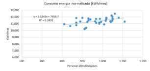
Para la verificación del modelo de línea base se comparan los valores de energía medidos o recopilados durante el periodo de la línea base con los valores que se obtienen usando el modelo de línea base. Esta comparación se puede hacer calculando el error para cada observación y calculando el promedio de estos errores de la siguiente manera:
