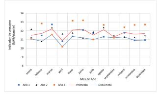
Se observa que para cada mes en específico hay al menos un valor del coeficiente de consumo por debajo del promedio. Bajo las mismas condiciones de operación, la edificación puede reducir su consumo al periodo donde operó con mayor eficiencia de consumo. Con lo anterior, se determina como ahorro potencial para cada mes la diferencia entre en consumo promedio y el coeficiente de consumo mínimo, y se determina el porcentaje de ahorro.
